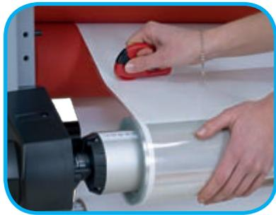
大切なラミネートローラーを保護するために安全カッターが用意されています。ローラーに傷をつけないように気を付けていただければいつまでも最高品質のラミネート加工を保証します。
